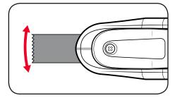
WARNING USE THE APPROPRIATE BLADE FOR THE WORKPIECE MATERIAL. THE METAL BLADE IS ONLY SUITABLE FOR NON-FERROUS METALS SUCH AS ALUMINIUM, COPPER & BRASS.
