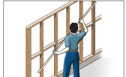
FIGURE 1 FRAME STRAIGHTNESS
